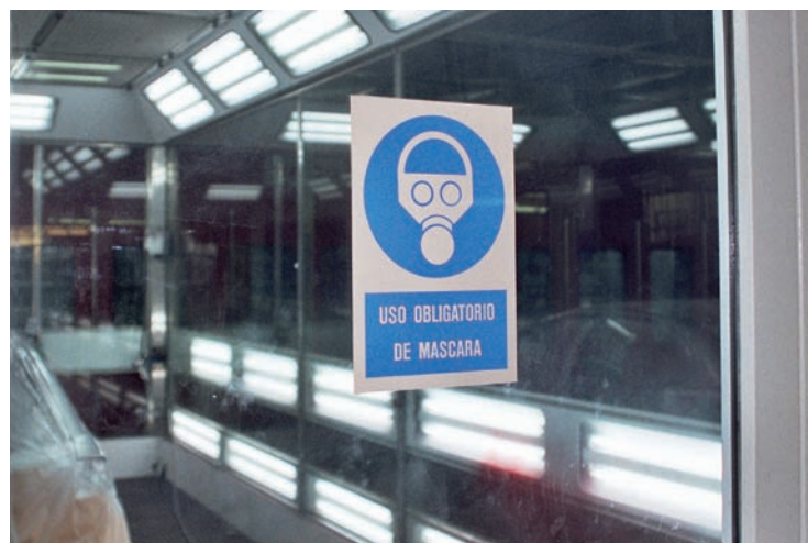
Señalización de uso obligatorio de mascarilla.
