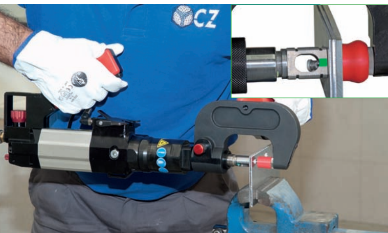
Extracción de remaches autopunzantes.
